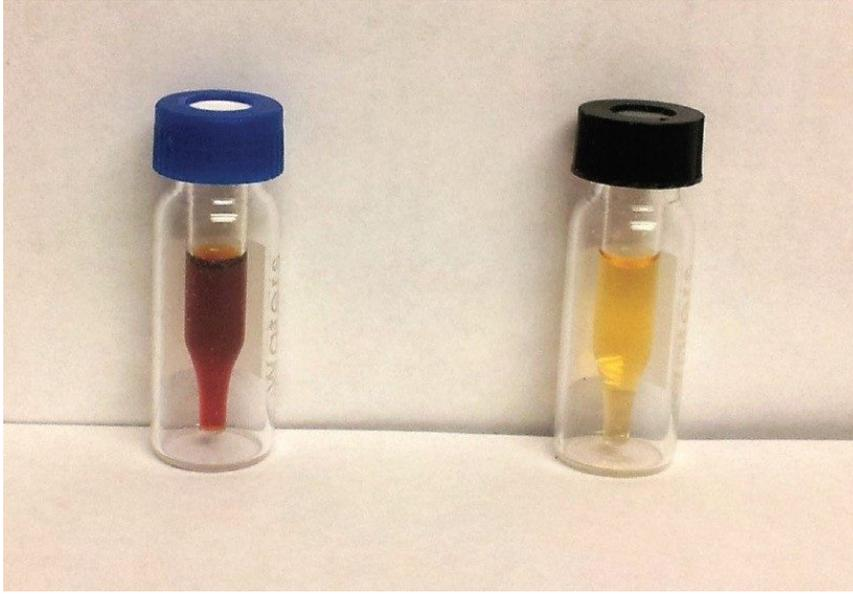
図 3. 固相抽出 (SPE) によるクリーンアップ。左のバイアルはクリーンアップなしのチリオレオレジンのサンプルを示し、右のバイアルはクリーンアップおよび濃縮後のチリオレオレジンサンプルを示しています。
