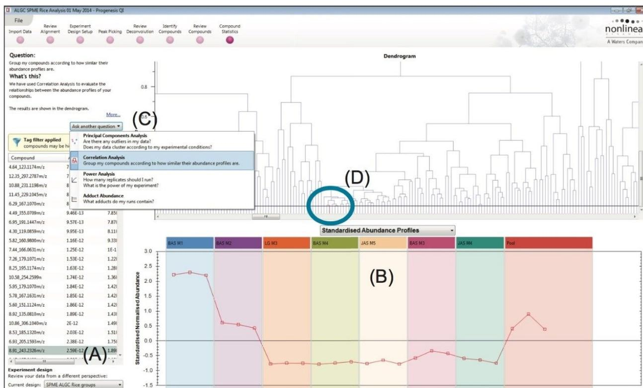
図 5. Progenesis QI 内で相関分析にアクセスして使用すること (C) により、選択したマーカーと同様のプロファイルを示す対象イオンをさらに抽出することができます (B)
