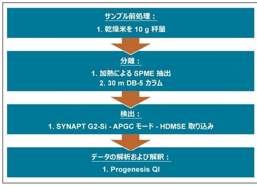
図 1. この試験における米サンプルの分析ワークフロー
