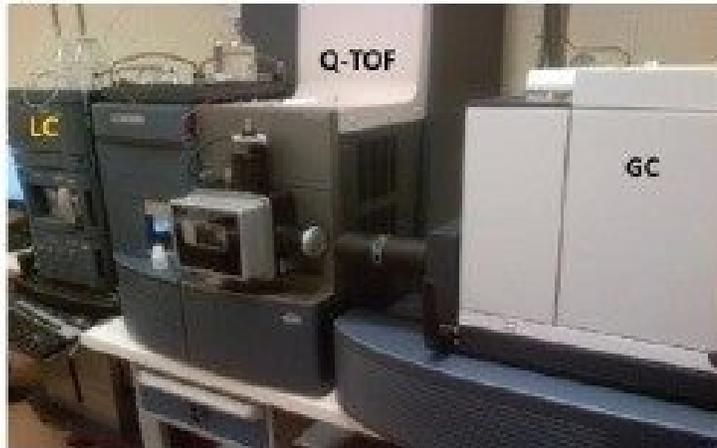
図 1a. 大気圧ガスクロマトグラフィー (APGC) イオン源、1b.Xevo G2-XS QToF 質量分析計
