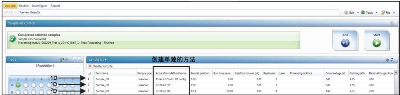
图4. 创建2D数据采集方法。必须在分析方法中加入Acquisition Method Name（采集方法名称）字段才能创建独立的1D和2D方法。将该字段选作已优化参数后，用户即可将单独的采集方法放入队列。所示方法分别用于1D Pro A、1D Pro A中心切割和2D RPLC/MS分析。
