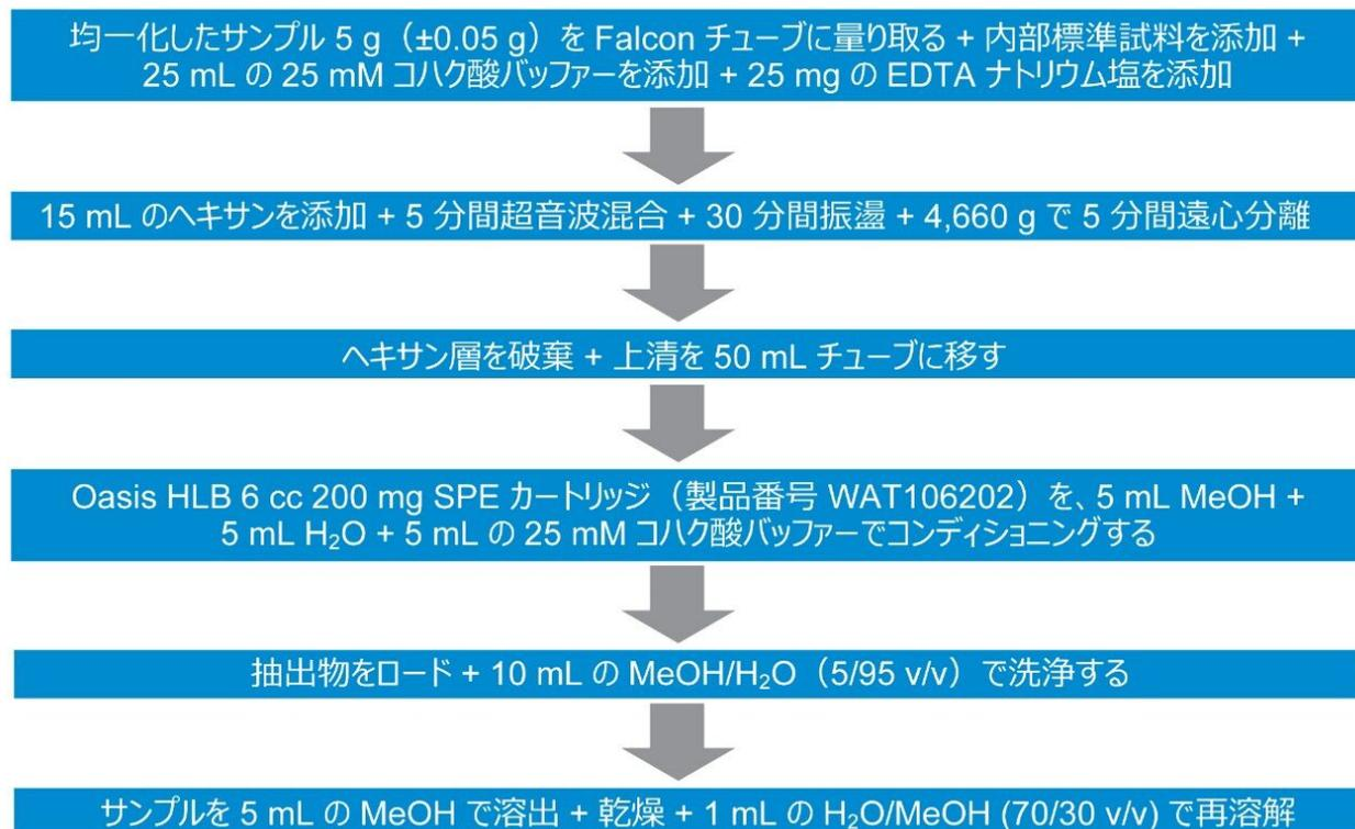
図 1. サンプル前処理ステップの概要
