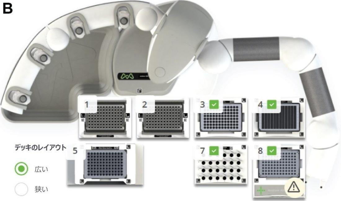
図 1. A) 8 サンプル用 GlycoWorks RapiFluor-MS プロトコルのための Andrew+ のセットアップ図。B) 8 サンプル用 GlycoWorks RapiFluor-MS プロトコルのための Andrew+ のセットアップの OneLab 上面図。自動化デッキスペースの Domino は次の通りです： (1) 50 ~ 1200  $\mu$ L の Optifit チップを装着した Tip Insertion System Domino、 (2) 10 ~ 300  $\mu$ L の Optifit チップを装着した Tip Insertion System Domino、 (3) MaxPeak HPS 700  $\mu$ L 96 ウェルプレート付き QuanRecovery を装着した Storage Plate Domino、
