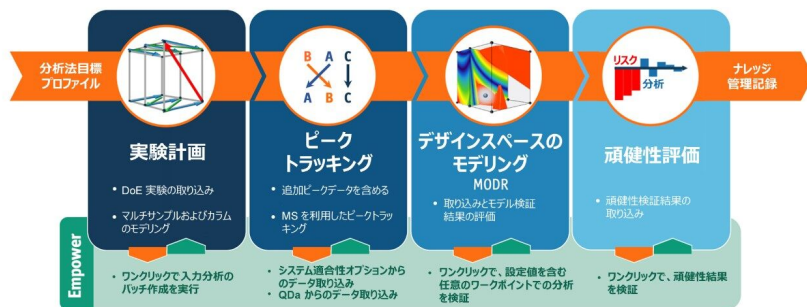
図 1. DryLab - Empower AQBd 分析法開発プロセスに含まれる複数のステップのワークフロー
