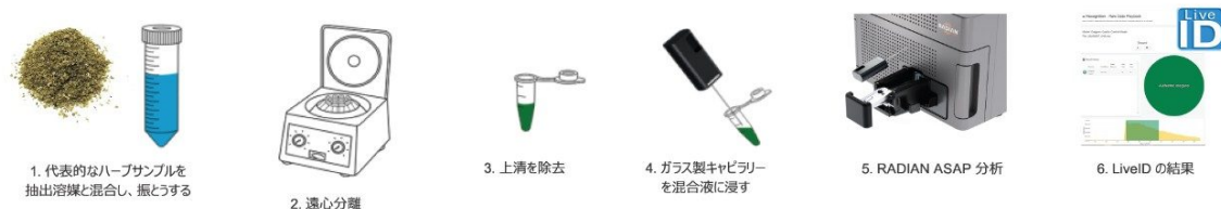
図 1. サンプルの乾燥および粉碎したハーブ材料から最終結果までの分析ワークフローステップ
