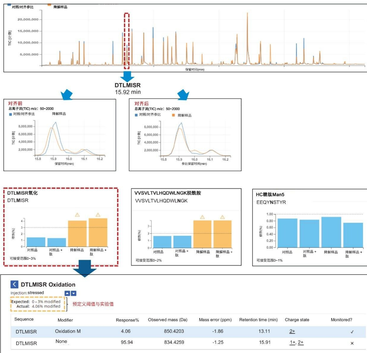
图5.保留时间对齐图(A)展示了对照品和对齐参比样品中DTLMISR肽段峰在对齐前和对齐后的叠加色谱图。显示了监测三种修饰肽（氧化、脱酰胺和糖基化）所得的属性肽结果（%丰度）。根据用户定义限值预定义的通过/失败标准决定了条形的颜色及其上方是否存在警告图标。下表显示了降解样品中DTLMISR Ox属性的目标标准和结果。
