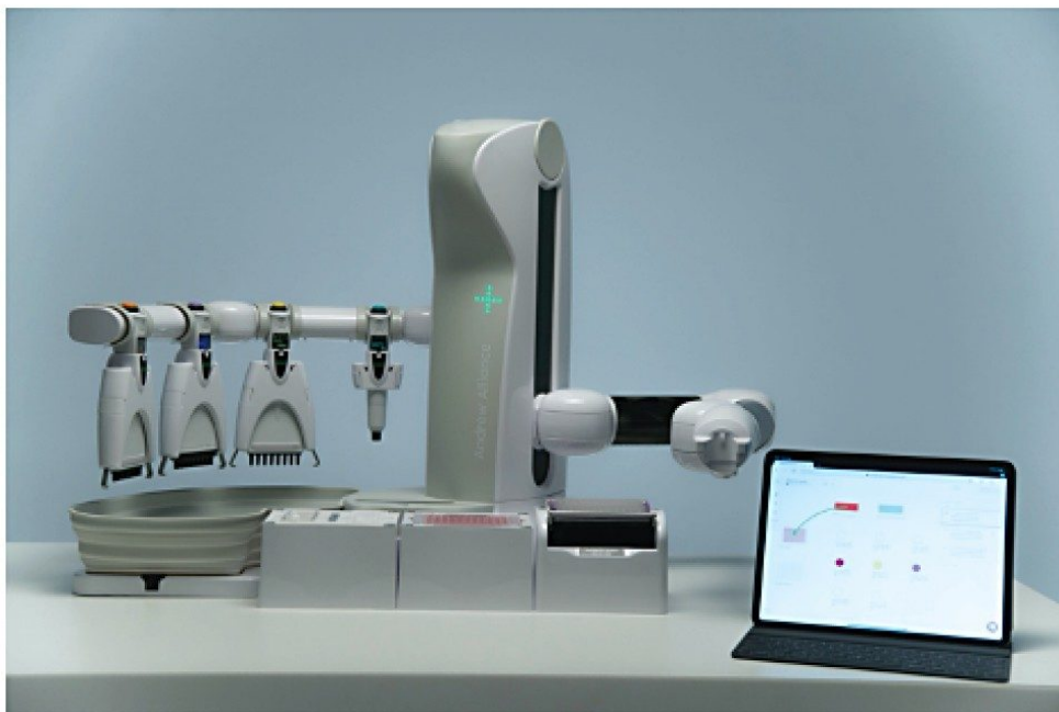
图1.Andrew+移液机器人和云端OneLab软件
