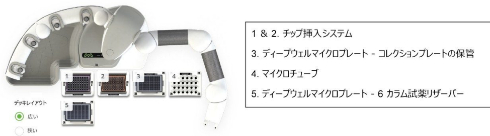
図 2. ピペット混合用 Andrew+ ピペットを使用して、ヒト尿中の EtG および EtS をサンプル前処理するための Andrew+ デッキのレイアウト
