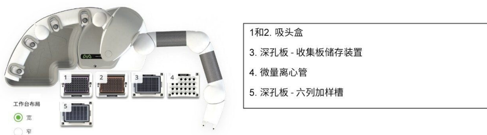
图2.使用Andrew+移液器混合方案对人尿液中的EtG和EtS进行样品制备的Andrew+工作台布局
