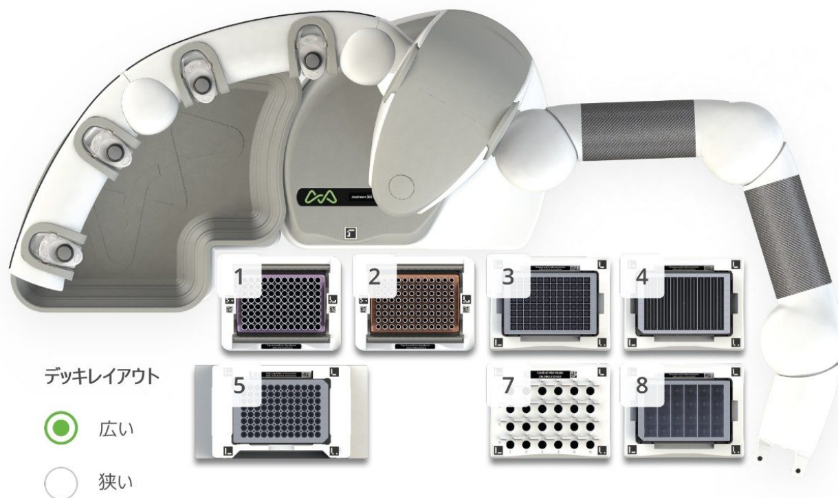
図 1. Andrew+ での MMA のデッキ構成- ドミノ： 1 および 2： チップ挿入システム。 3、 4 および 8： ディープウェルマイクロプレート。 5 -： Microelution プレート Vacuum+ 。 7： マイクロチューブ。
