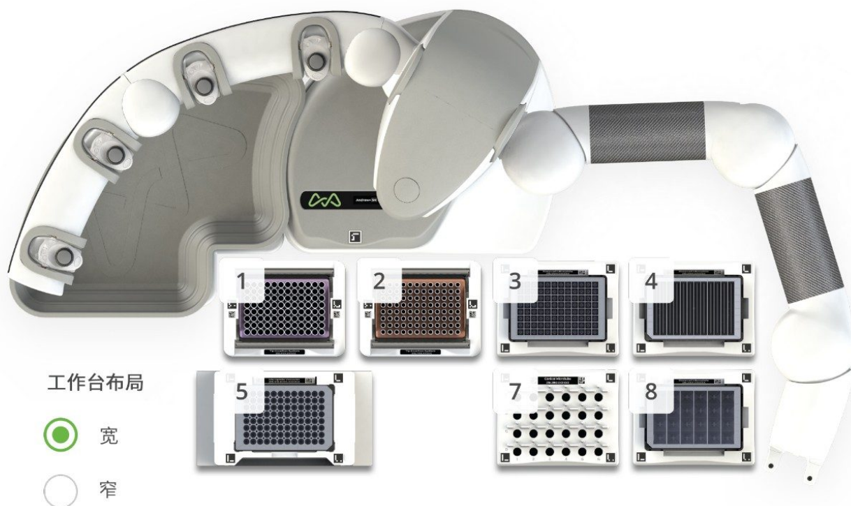
图1.Andrew+ MMA工作台配置 - Dominos: 1和2: 吸头盒; 3、4和8: 深孔板; 5: \mu Elution提取板Vacuum+ ; 7: 微量离心管
