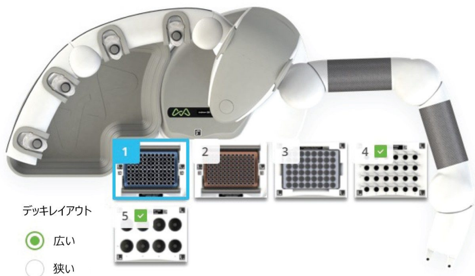
図 3. Andrew+ ロボットの概略図。各ドミノの位置、および選択したプロトコルに必要な内容が示されています。
