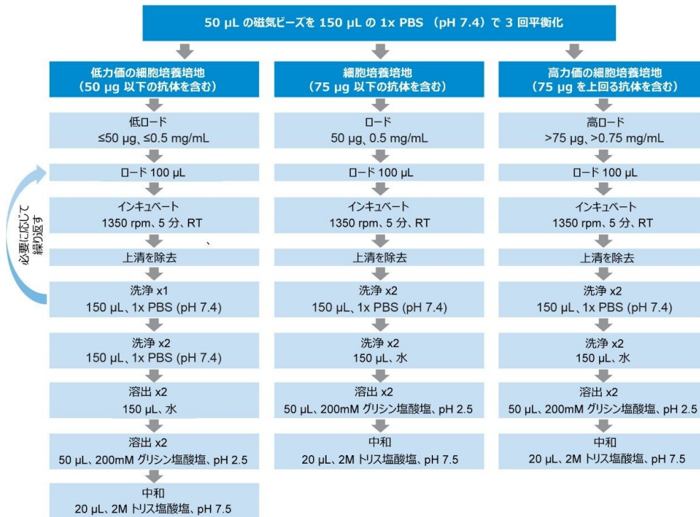
図 3. 自動抗体精製手順のフロー図。ここでは、細胞培養培地中のさまざまな力価およびロード量の抗体（低 \leq 50 \mu\text{g} 、標準 \leq 75 \mu\text{g} 、高 > 75 \mu\text{g} ）に対応する 3 種の手順が示されています。RT: 室温。
