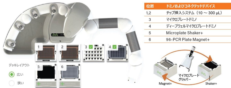
図 4. 迅速自動化抗体精製 8 サンプルプロトコル用の Andrew+ ドミノおよびコネクテッドデバイスの構成。完全自動プロトコルでは、Andrew+ に 2 つのコネクテッドデバイス（Magnet+ および Shaker+）とマイクロプレートグリッパーまたはマイクロプレートグラバールが必要で、8 サンプルの実行時間は 35 分です。
