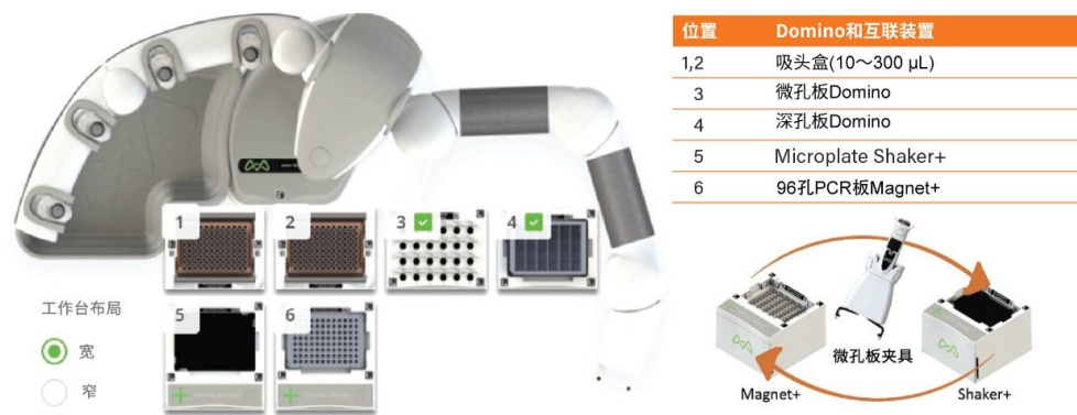
图4.8样品抗体快速自动纯化方案的Andrew+ Dominos和互联装置配置。在全自动方案中，Andrew+需要使用两个互联装置（Magnet+和Shaker+）、一个微孔板夹具或微孔板抓取器。8个样品的运行时间为35 min。
