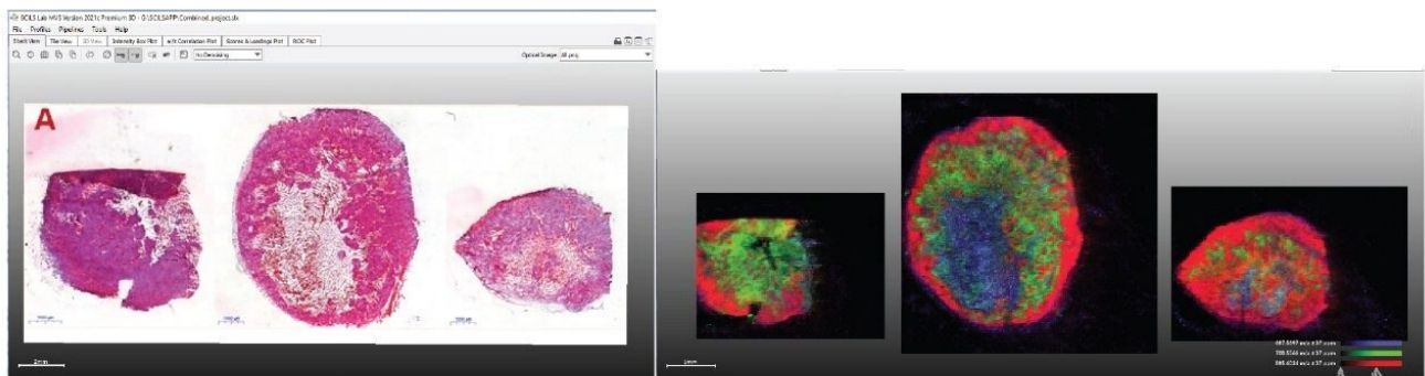
図4. 同じプロジェクト内のマルチサンプルの RGB 重ね描きによる複数イオンの分布の表示 ( m/z 885.6 (赤)、700.5 (緑)、687.6 (青))
