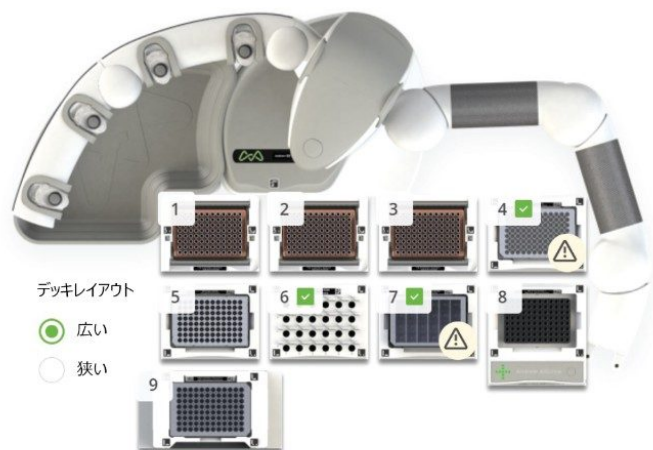
図4. GlycoWorks RapiFluor-MS 迅速自動還元 32 サンプルプロトコルのための Andrew+ のドミノ構成。構成は3列のドミノ用です。32 サンプルの実行時間は1時間です。
