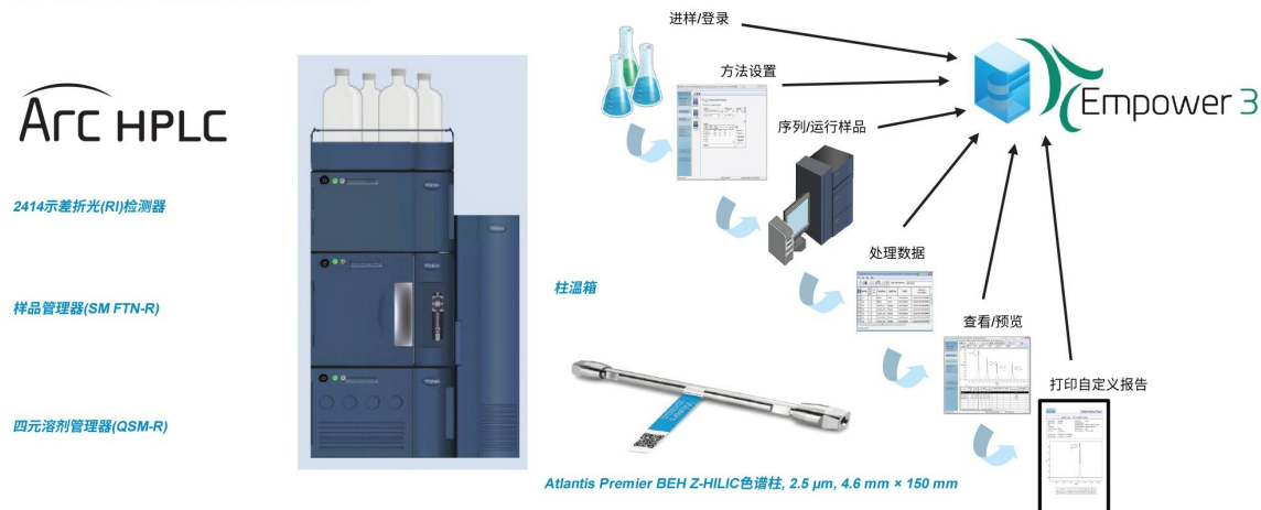
图2. 使用 Arc HPLC 系统与 Empower 软件分析糖醇和阿洛酮糖产品的分析工作流程解决方案
