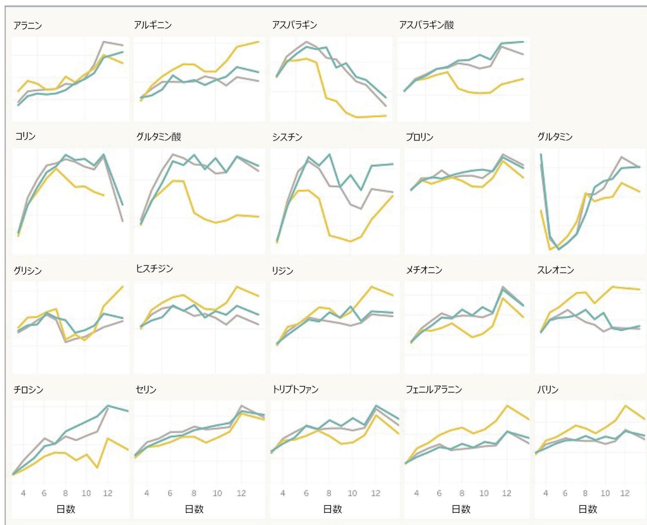
図2. 3つの異なる容器からの代表的な化合物のレスポンスの、サンプリング時間に対するプロットの重ね描き。緑色の線：容器 CS1:01（培地1 - フィード1）、オレンジ色の線：容器 CS1:05（培地2 - フィード2）、グレー色の線：容器 CS1:09（培地1 - フィード3）。
