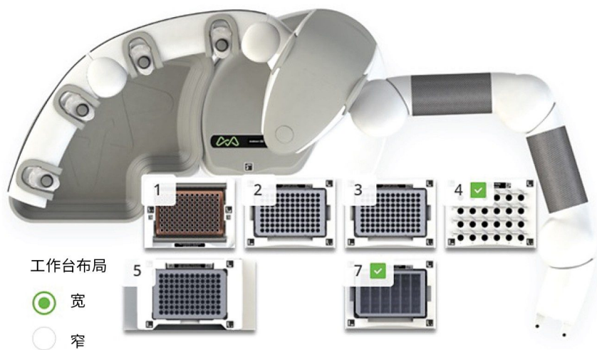
图1. Andrew+移液机器人工作台布局。
