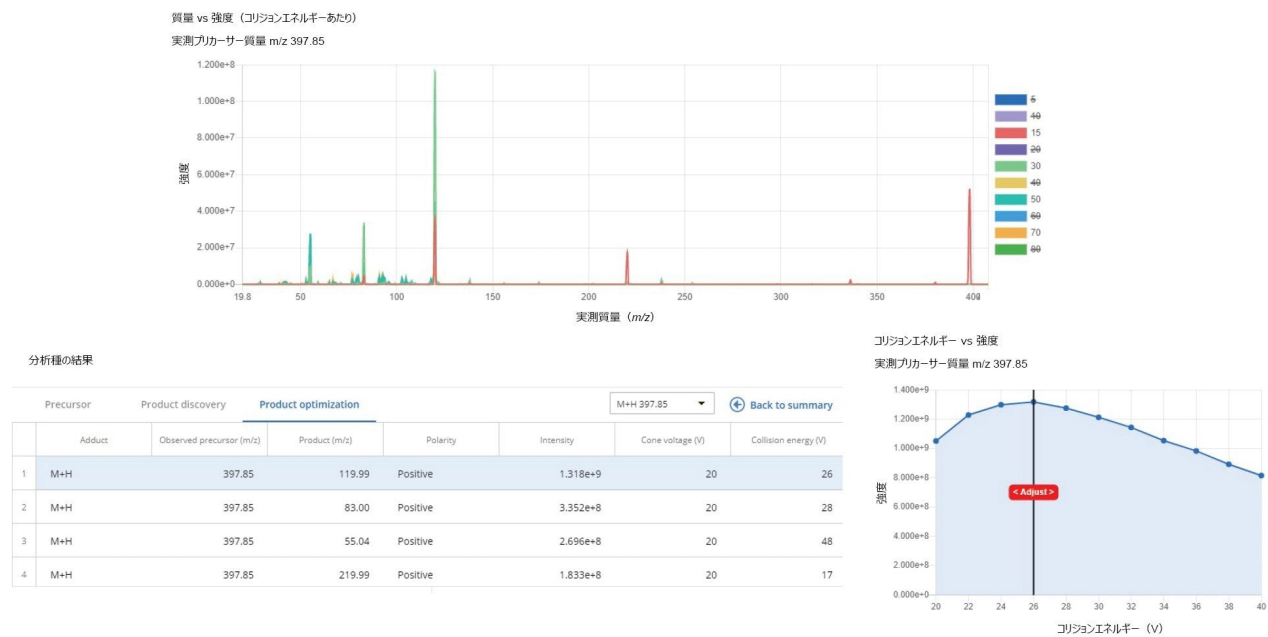
図 2. 最適化ツールの出力例: コリジョンエネルギーの関数としてのエチミジンの質量スペクトル (上)、最適化された最初の 4 つのプロダクトイオンを含む表 (左下)、プロダクトイオン m/z 120 の双方向コリジョンエネルギープロット (右下)
