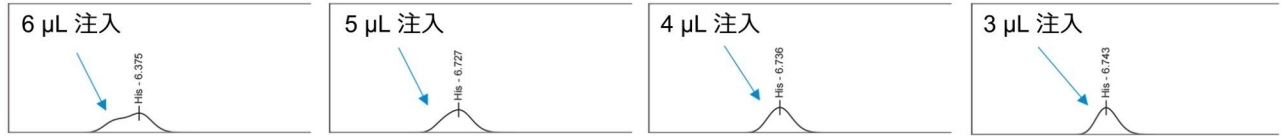
図 1. Arc HPLC で得られたタンパク質加水分解物 AA 標準試料（500 \mu M）のクロマトグラムからの注入量の決定
