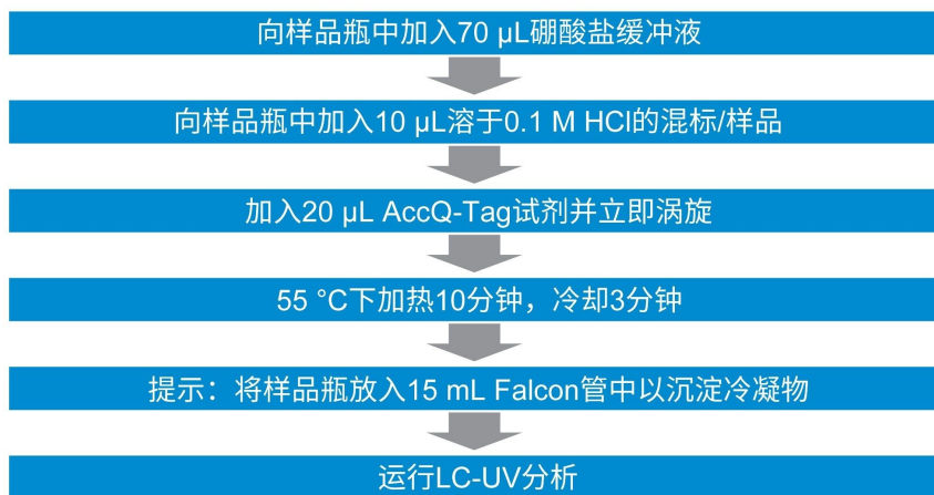
图1.液体样品的衍生化工作流程。内标已预先添加到硼酸盐缓冲液中。
