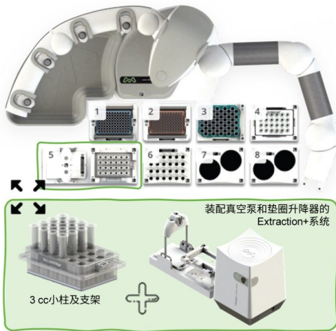
图5.Andrew+ 搭配Extraction+，包括方案图示、系统组件标识和Andrew+工作台布局。
