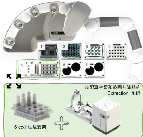
图6.Andrew+ 搭配Extraction+，包括方案图示、系统组件标识和Andrew+工作台布局。
