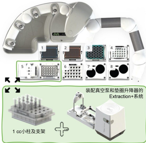
图4.Andrew+搭配Extraction+, 包括方案图示、系统组件标识和Andrew+工作台布局。
