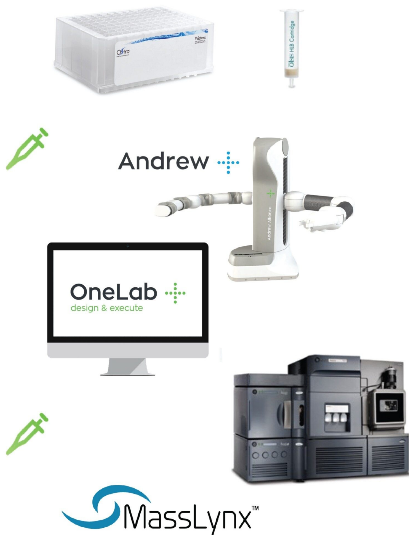
図 1. Oasis HLB SPE プレートおよびカートリッジ、および Extraction+ コネクテッドデバイスと Andrew+ ピペッティングロボットの組み合わせを使用する自動 SPE サンプル抽出および LC-MS 分析ワークフローの図示
