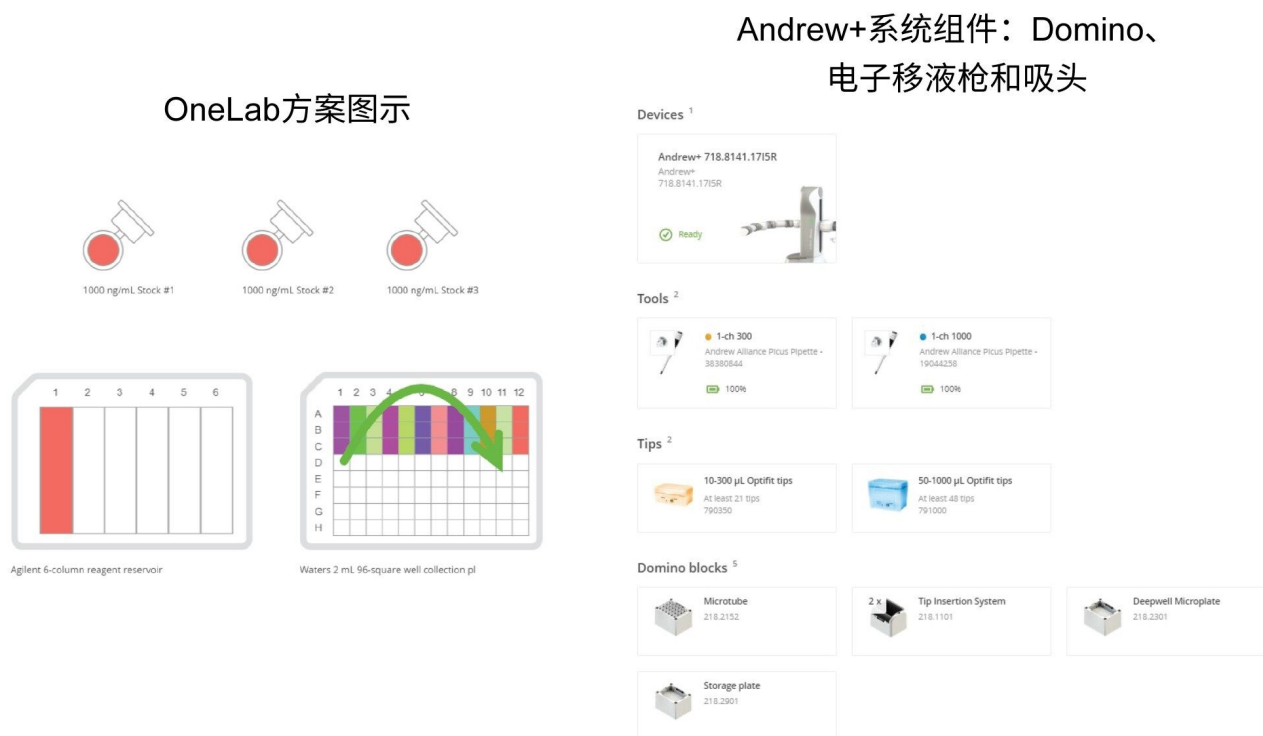
图2. OneLab方法使用的仪器列表和样品稀释方案图示如上。移液枪、移液枪吸头、Domino和所需实验器皿见右图
