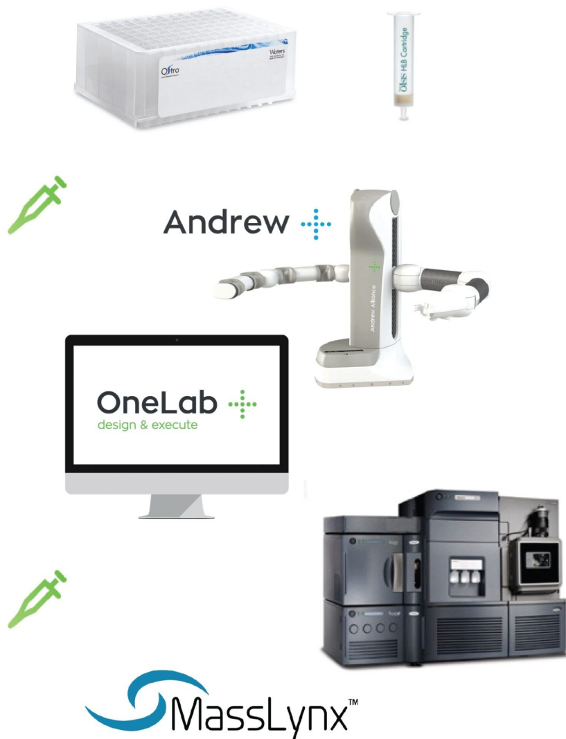
图1.使用Oasis HLB SPE板和小柱以及Andrew+移液机器人搭配Extraction+互联装置进行的全自动SPE样品萃取和LC-MS分析流程图示。
