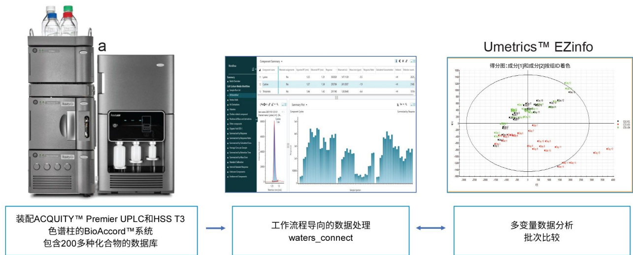
图示1. BioAccord系统/waters_connect™细胞培养基分析工作流程示意图。
