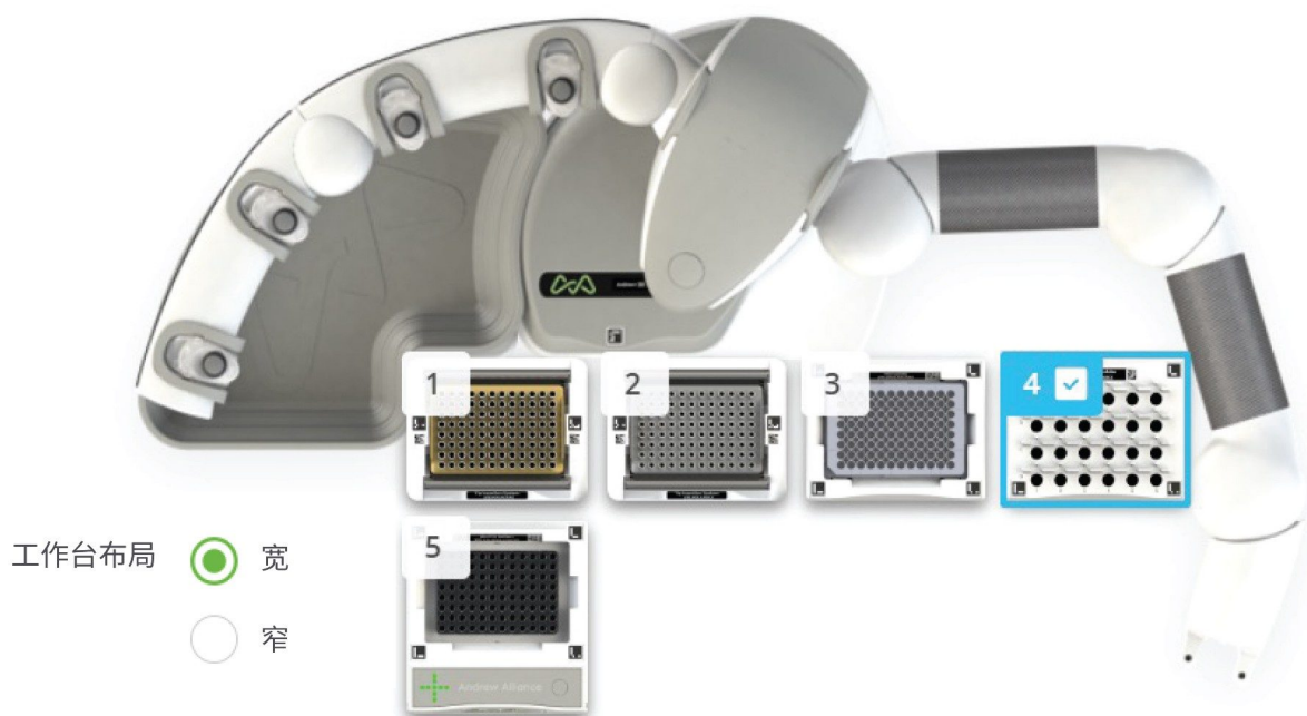
图2.使用Andrew+移液器和Domino模块制备标准品和样品的Andrew+工作台布局：1.吸头盒（5~120 \mu\text{L} Optifit吸头）；2.吸头盒（0.2~10 \mu\text{L} Optifit吸头）；3.微孔板；4.微量离心管；5.96-PCR板Peltier+
