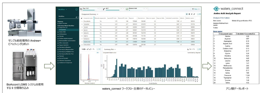
図 1. Andrew+ ピペッティングロボットおよび BioAccord LC-MS プラットホームに基づく、細胞培養培地中の栄養成分および代謝物の分析のためのサンプル前処理、LC-MS 分析、レポートの概略
