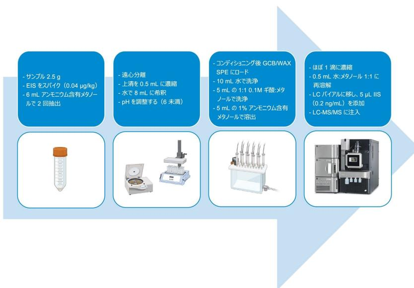
図 1. 野菜、果物、ベビーフードサンプルの抽出およびクリーンアッププロトコルの概略図
