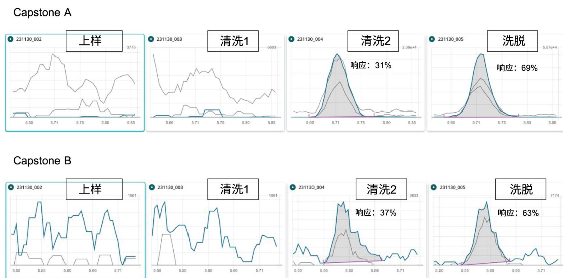
图8.SPE方案中各馏分的Capstone A（上图）和Capstone B（下图）色谱图。清洗1=使用水的清洗步骤，清洗2=使用1:1 0.1 M甲酸:甲醇的清洗步骤。蓝色迹线：定量离子对，灰色迹线：定性离子对。
