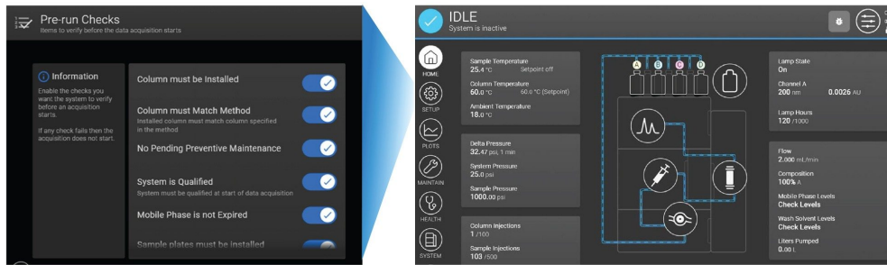
図 4. 分析前に設定可能なチェックリストは、Alliance iS Bio HPLC システムのタッチスクリーンインターフェースの Setup (セットアップ) にあります
